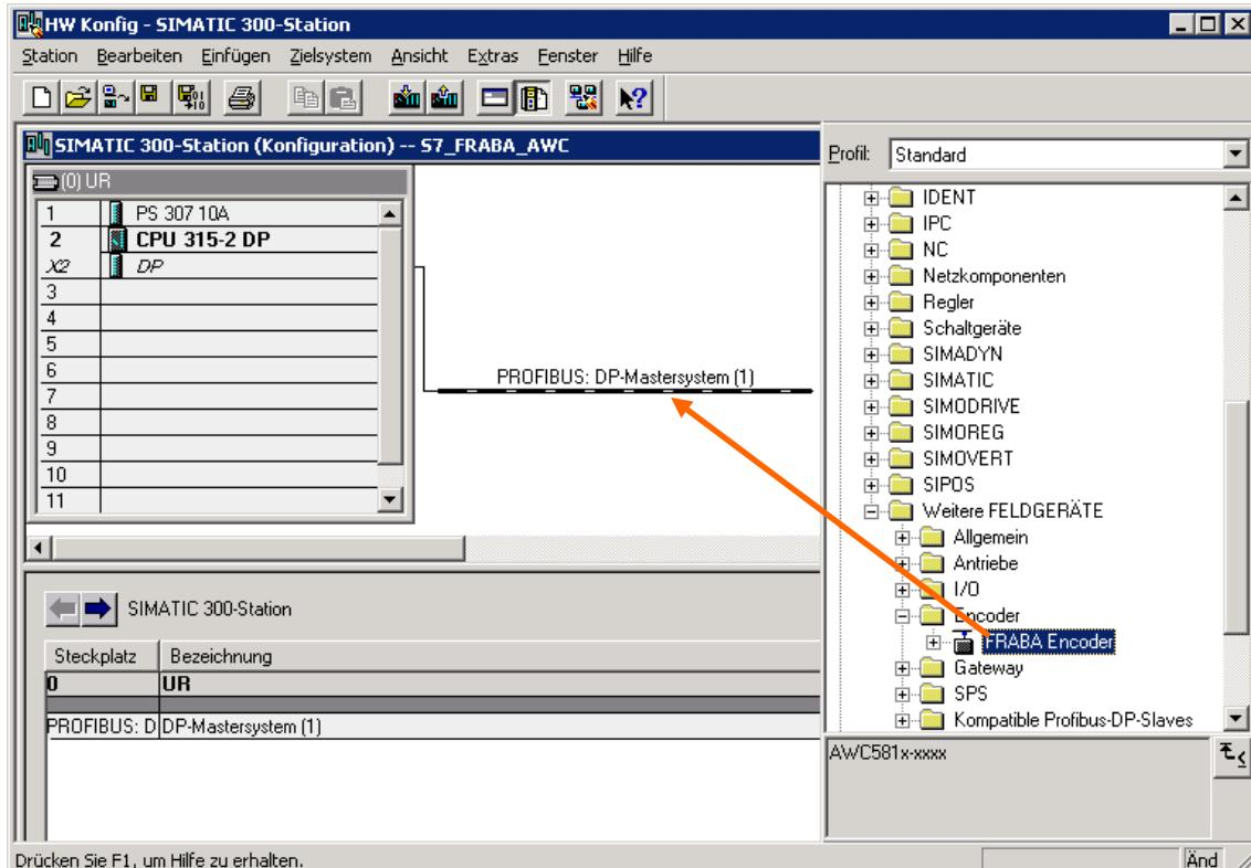
Nachdem über den Menüpunkt „Einfügen“ – „Mastersystem“ das Profibus-Netz im Hardwarekonfigurator projektiert wurde, kann der Absolutwertgeber aus dem Hardwarekatalog ausgewählt und in das Netz eingefügt werden. Hierzu wird das Gerät „FRABA Encoder“ per Drag&Drop an den Bus angekoppelt (oder Doppelklick auf das Modul bei markiertem Bus).
