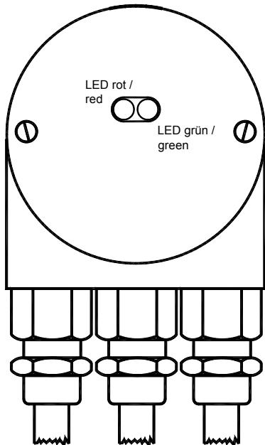
Die Anschlusshaube verfügt über zwei LEDs, die optisch den Buszustand am Winkelcodierer darstellen. Die rote LED dient zur Anzeige von Fehlern, die grüne LED zur Statusanzeige des Winkelcodierers. Jede LED kann sich in drei Zuständen befinden: aus, an, blinkend. Von den neun Kombinationsmöglichkeiten werden sieben genutzt, um einen speziellen Zustand anzuzeigen.
