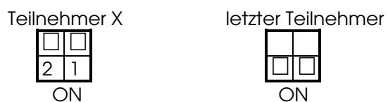
Die Einstellung der Profibus-Teilnehmeradresse erfolgt über DIP-Schalter in der Anschlußhaube. Mögliche (erlaubte) Adressen liegen zwischen 3 und 124 (dezimal); wobei jede nur einmal vorkommen darf. Die Anschlußhaube kann einfach vom Endanwender durch Lösen von zwei Schrauben am Winkelcodierer zur Installation entfernt werden. In folgendem Beispiel wurde die Teilnehmeradresse 123 (dezimal) eingestellt:
