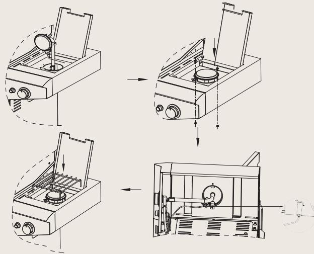
**Passaggio 6** - a) Spingere la parte dell'accensione attraverso il foro nella parte anteriore del fornello laterale e installare il controdado.
