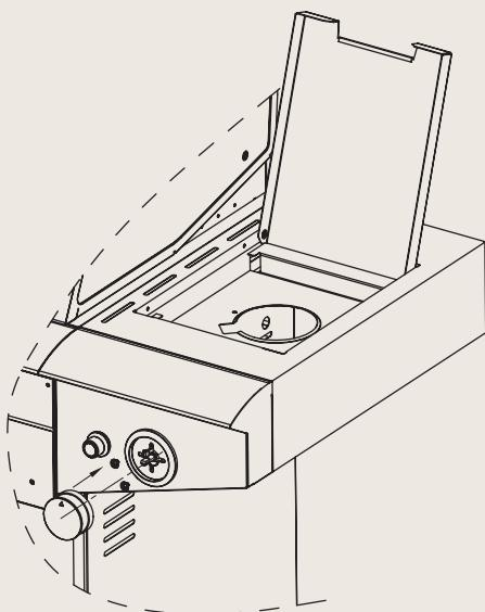
**Passaggio 5** - a) Far scorrere il tubo del fornello laterale e fissarlo con 2 viti.
