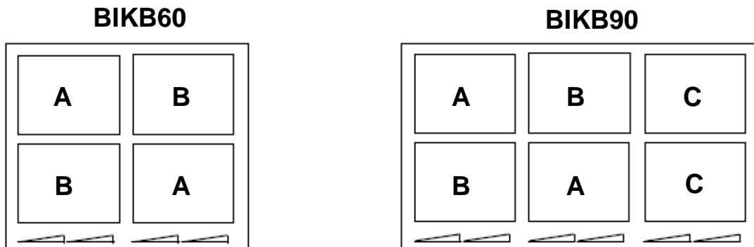
Die Kochmulde ist mit einer Höchstleistung ausgestattet. Um diese Höchstleistung nicht zu überschreiten, reduziert die Elektronik automatisch das Kochniveau einer anderen Kochzone wenn die Booster-Funktion aktiviert ist. Diese Kochzone wird dann blinkend die reduzierte Leistung [ 9 ] anzeigen.
