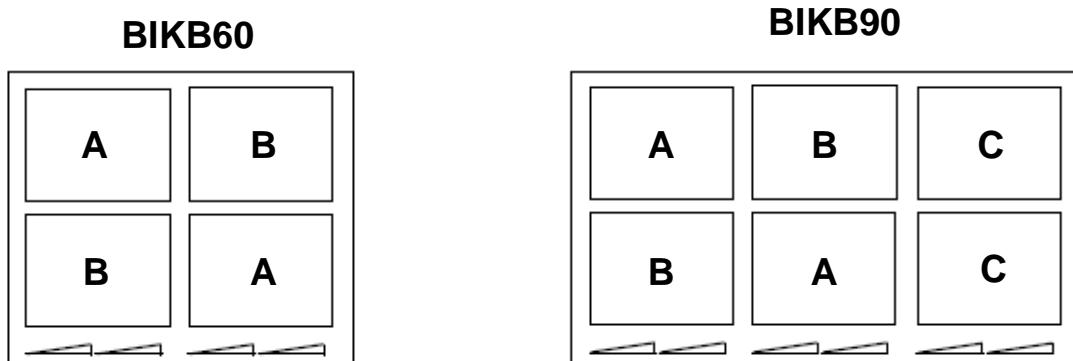
Als deze vermogensgrens bij het inschakelen van een hoge kookstand of de powerfunctie wordt overschreden, reduceert het powermanagement de kookstand van de bijbehorende module-kookzone. De aanwijzing van deze kookzone knippert eerst, daarna wordt de maximaal mogelijke kookstand constant getoond.
