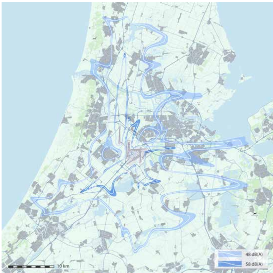
Figuur 5.1 Verwachte jaargemiddelde geluidbelasting over het etmaal L_{den} voor het gebruiksjaar 2018, met spreiding als gevolg van weersvariaties
