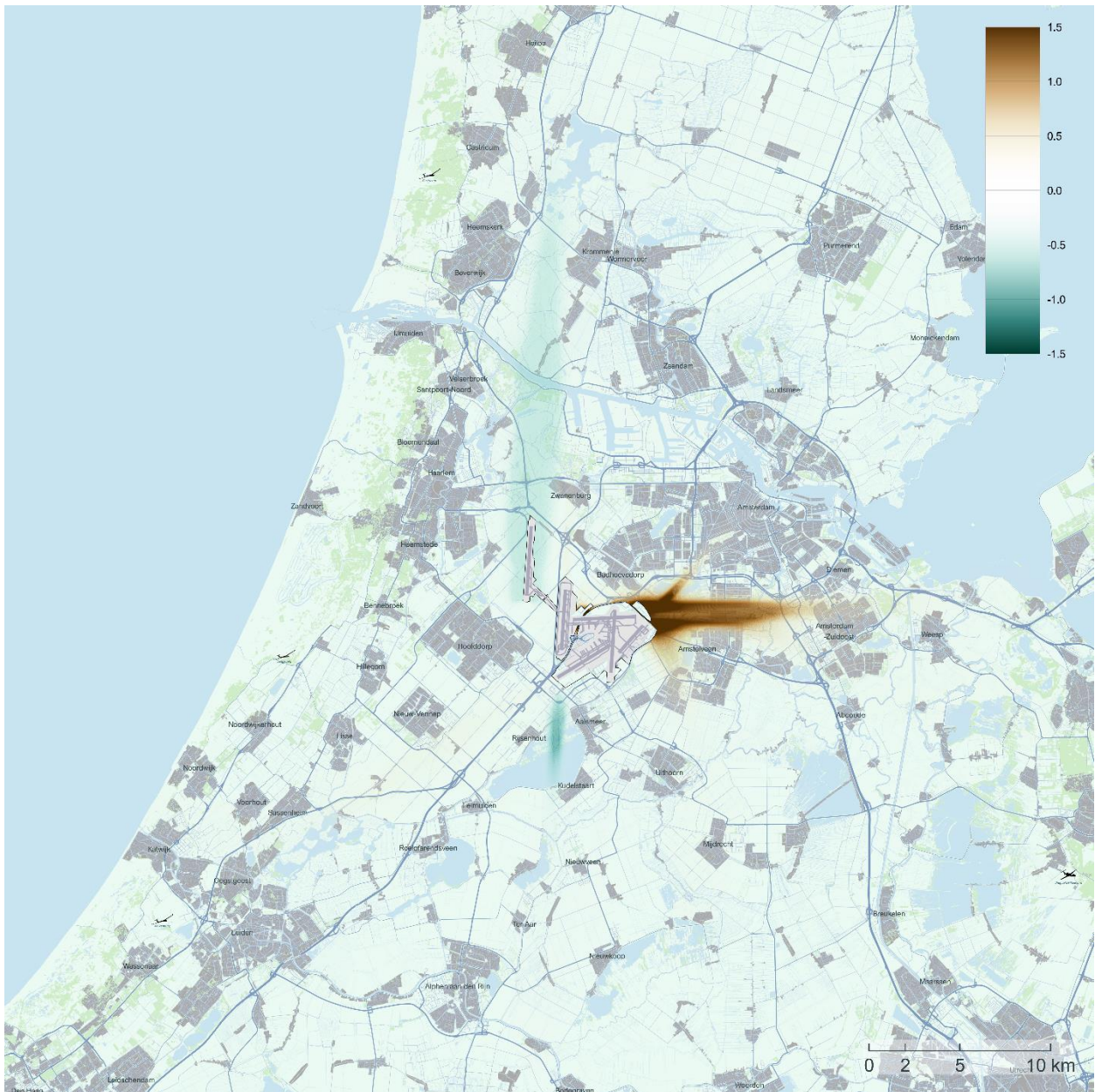
Figuur 36: Verschuiving in lokale geluidbelasting voor de periode van de geplande onderhoudswerkzaamheden aan rijbaan ALPHA (4 mei 2026 tot en met 28 juni 2026) met het normaal onderhoud aan de Polderbaan en Zwanenburgbaan voor de etmaalperiode.
