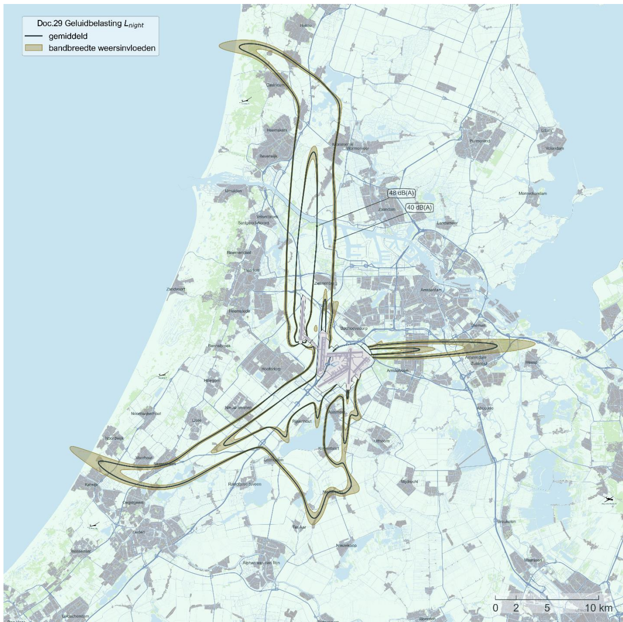
Figuur 14: Verwachte jaargemiddelde geluidbelasting voor de nachtperiode L_{NIGHT} met spreiding als gevolg van weersvariaties (op basis van Doc.29) inclusief de effecten als gevolg van (rij)baanonderhoud
