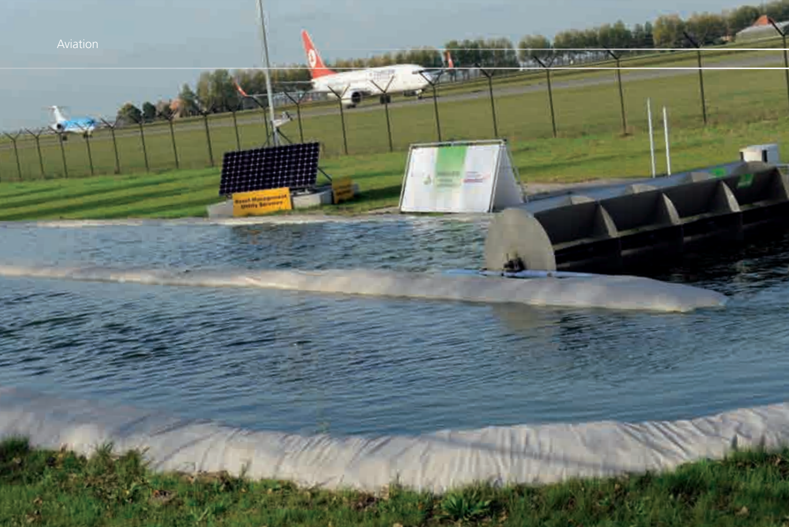
Het micro-wierenbassin is een van de duurzame innovaties die dit jaar zijn gestart. Doel van dit algenbad is om te testen of glycol en kaliumacetaat, met behulp van algen milieuvriendelijk kunnen worden afgebroken in water. Micro-wieren produceren grote hoeveelheden zuurstof waardoor glycol wordt afgebroken. De vrijgekomen kooldioxide nemen de micro-wieren weer op en wat overblijft is gezuiverd zuurstofrijk water en algenbiomassa.
