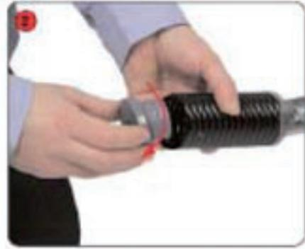
2 Enroscar las boquillas de plástico en las patas de goma (silent-block) enganchados al marco
