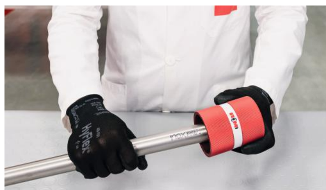
26. attēls — caurules atskarpju noņemšana
