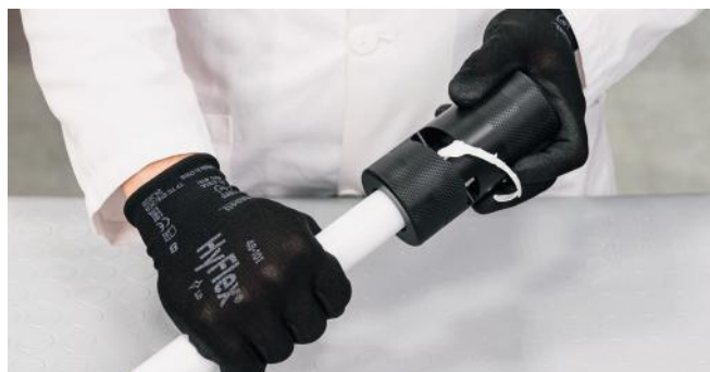
29. attēls — pārklājuma noņemšana (steelPRES ar PP pārklājumu)
