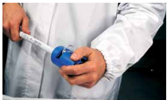
29. attēls - Pārklājuma noņemšana (Steelpres ar PP pārklājumu)
