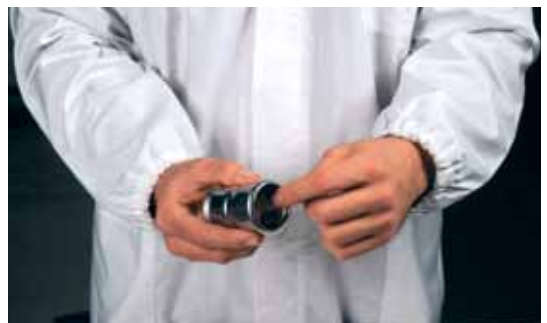
30. attēls - Gredzenblīves pārbaude
