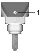
**Com câmara de medição (máx. 15bar)**
