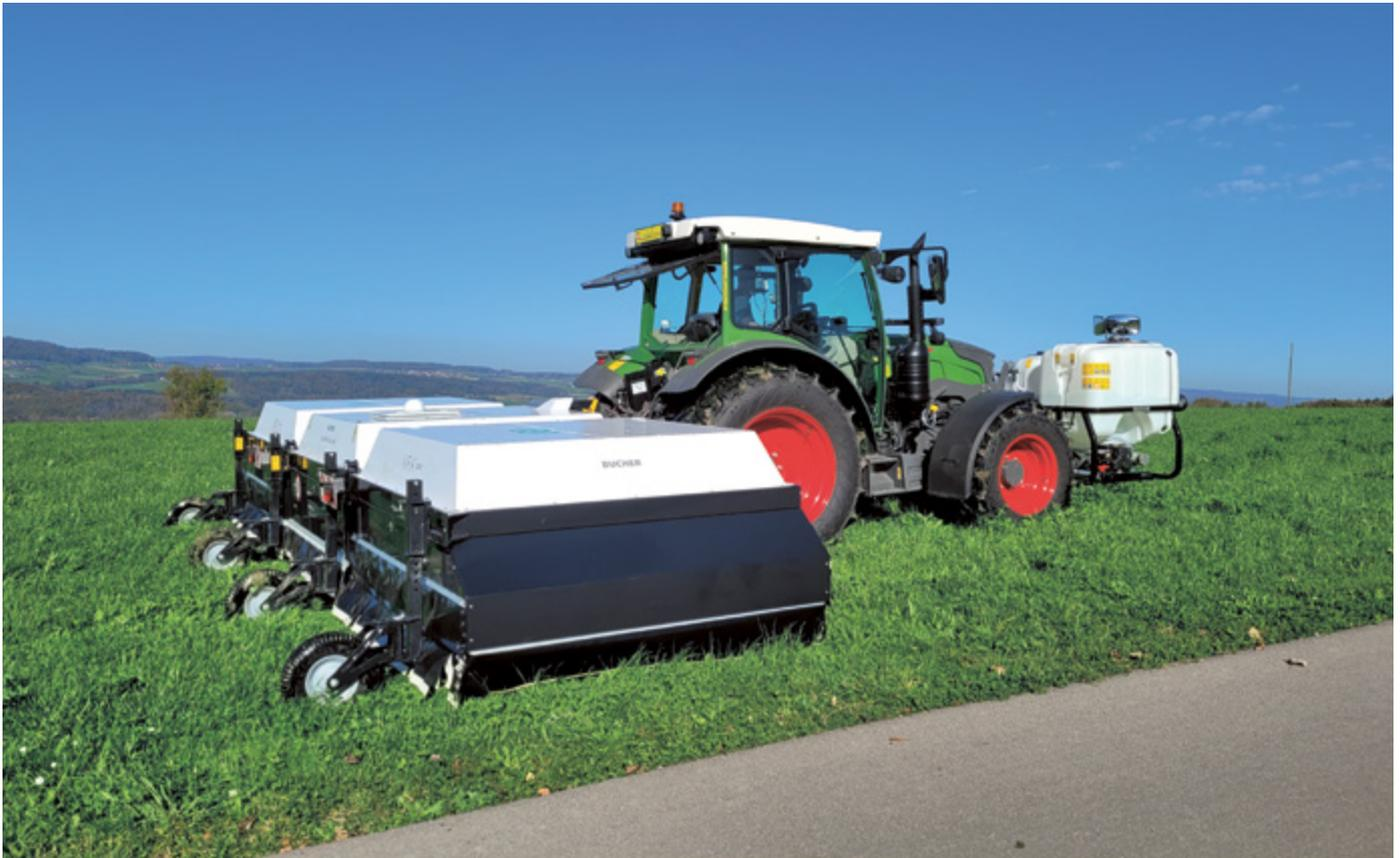
Moderne Technologie bei der Unkrautbekämpfung mit dem ecoRobotix
