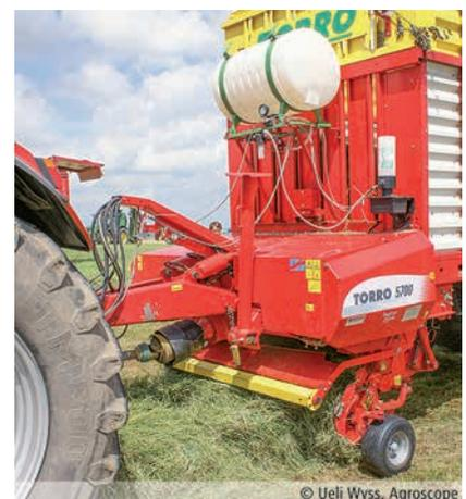
Ein Dosiergerät ermöglicht es, Siliermittel gleichmässig zu verteilen.
