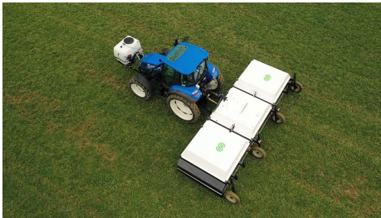
Abb. 1: ARA-Anhänger, hochpräzise Behandlung Pflanze für Pflanze, Quelle ecoRobotix 2021
