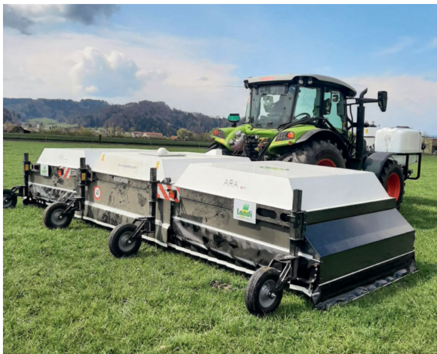
Die Präzisions-spritze von Ecorobotix ist sechs Meter breit und hat 156 Düsen. Diese öffnen sich nur, wenn sie sich direkt über einer Fläche befinden, die von der Kamera als zu behandeln identifiziert wird.
