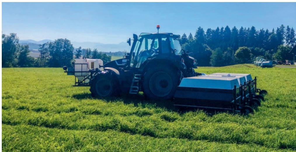
Der ecoRobotix im Einsatz. Das kameragesteuerte Hochpräzisionsprühergerät behandelt mit seiner präzisen Behandlung praktisch lückenlos Blacke für Blacke und ermöglicht eine Pflanzenschutzmitteleinsparung bis zu 90 Prozent.
