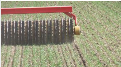
Cambridwalze bei trockenen Bedingungen zur Rückverfestigung und Bodenschluss
