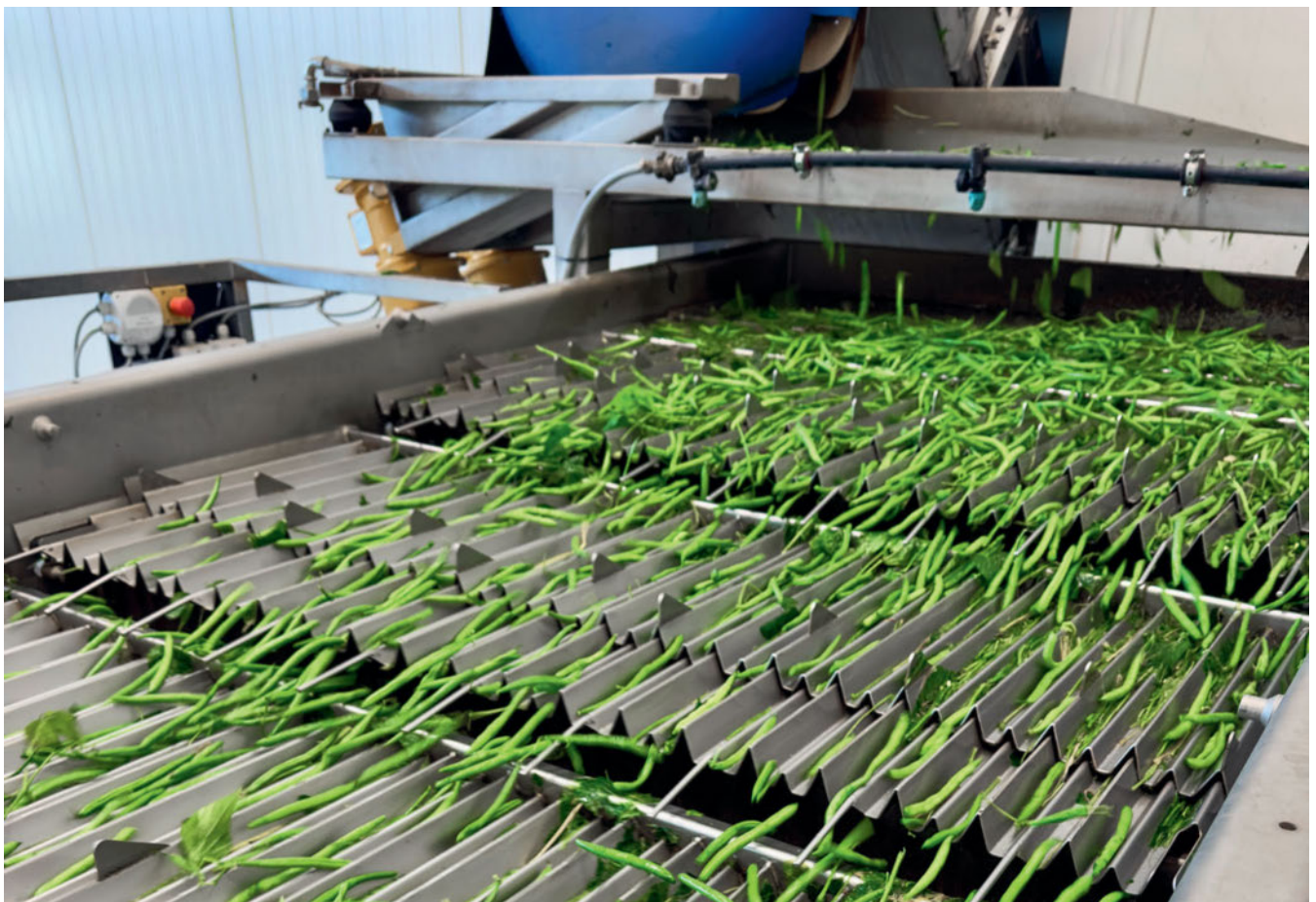
Der Längenkalibrierer stellt die Weichen: ab in den Frischkonsum oder in die Dörranlage.
