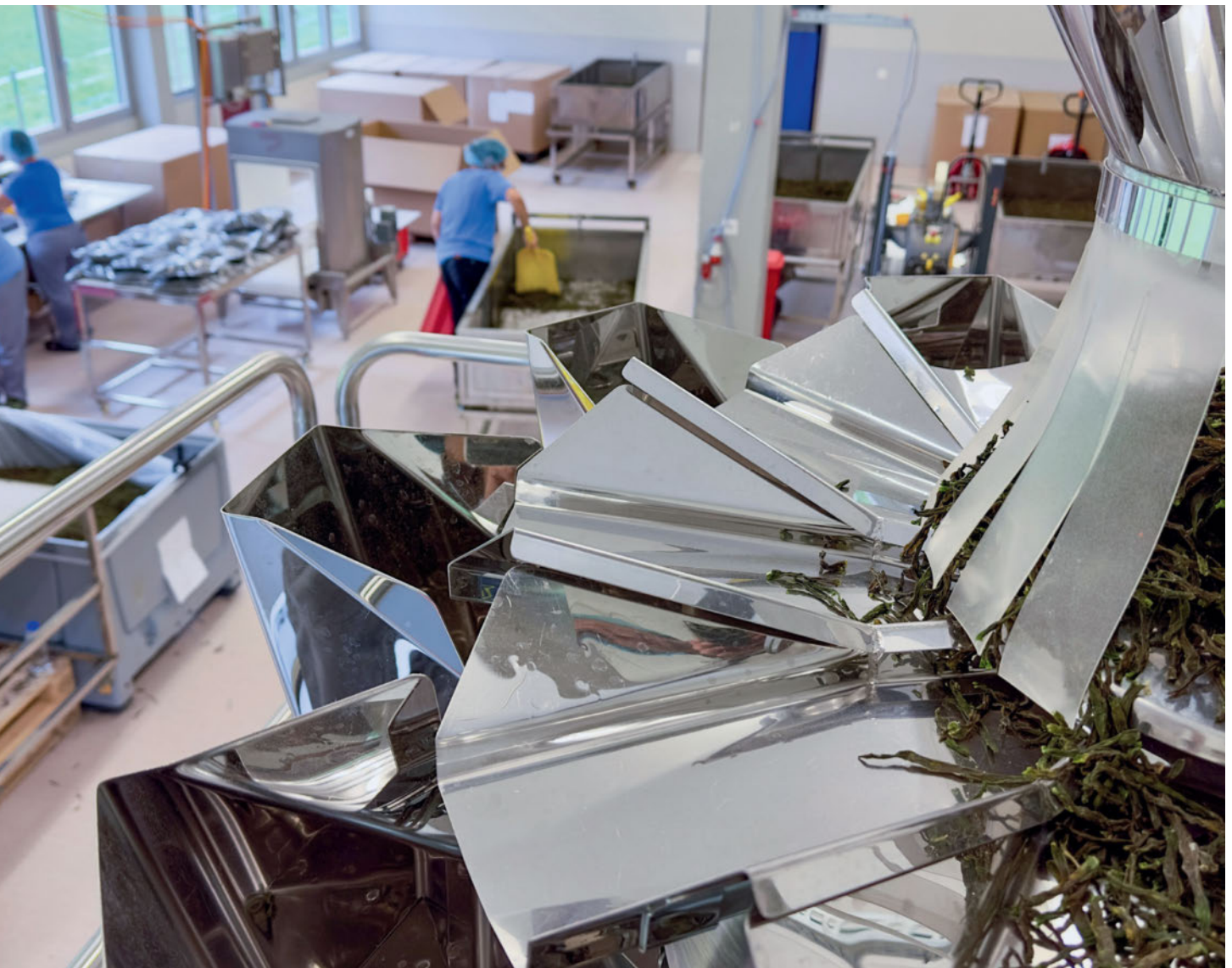
Nach der genauen Schlusskontrolle sind die Dörrbohnen parat fürs Abfüllen durch die Mehrkopfwaaage in 100-Gramm-Beutel, per Hand in 1- und 2-Kilo-Säcke.
