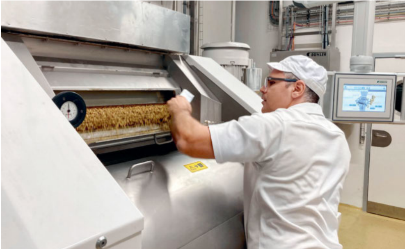
Erwin Waldvogel prüft den Flockierungsvorgang in der Swissmill-Hafermühle. Bild: Samuel Eckstein
