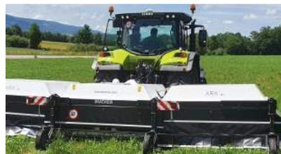
Dies ist ein kameragesteuertes Hochpräzisions-sprühgerät, wobei der PSM-Einsatz reduziert werden kann.
