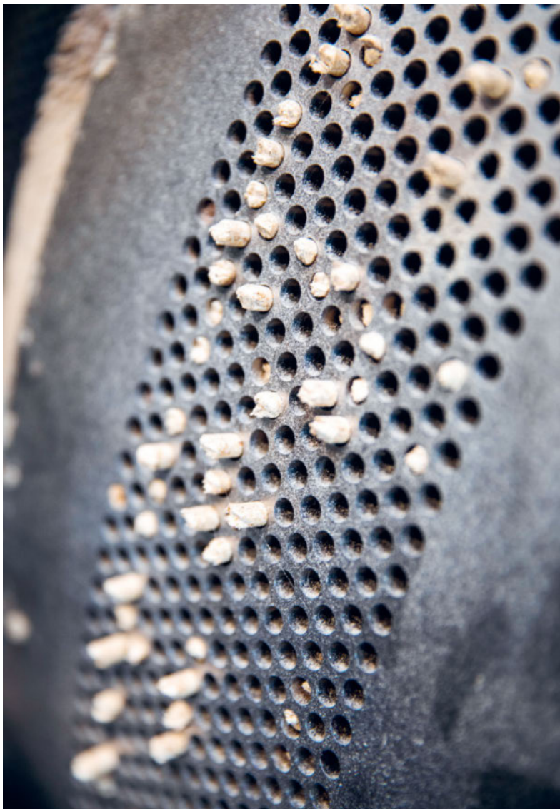
Das zerkleinerte Holz wird unter hohem Druck durch Matrizen gepresst. Bild: Esther Michel
