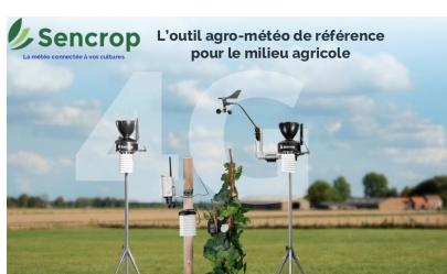
Die große Neuerung liegt in der **Modularität**: Jede Station kann bis zu drei austauschbare Sensoren aufnehmen. Die Landwirte müssen nicht mehr das gesamte Gerät austauschen, sondern nur noch das betreffende Modul, was die Kosten senkt und gleichzeitig die
