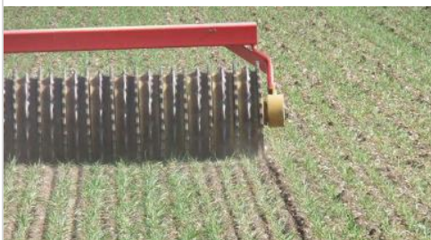
Cambridwalze bei trockenen Bedingungen zur Rückverfestigung und Bodenschluss Bild: Adrian Sutter
