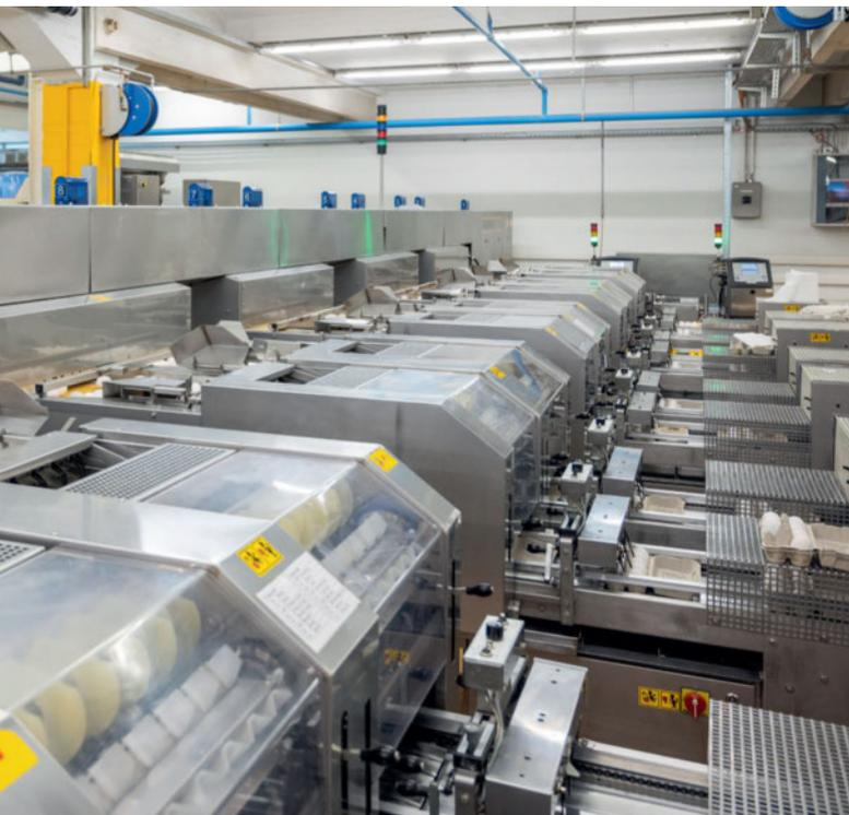
Auf dieser Maschine werden die Eier bei EiCO nach Grösse und Gewicht sortiert.
