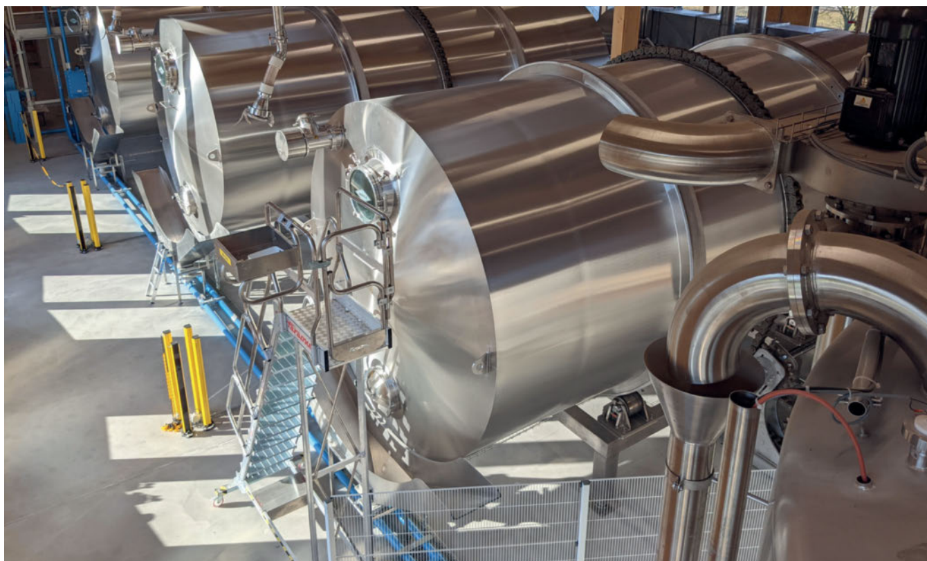
Die industrielle Mälzerei in Möriken-Wildegg verfügt über drei 10-Tonnen-Trommeln und produziert jährlich rund 1500 Tonnen Malz. Bild: Schweizer Mälzerei
