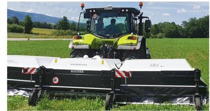
Dies ist ein kameragesteuertes Hochpräzisions-sprühgerät, wobei der PSM-Einsatz reduziert werden kann.
