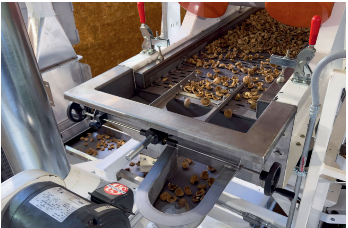
Der professionellste und effizienteste Nussknacker überhaupt: Bis zu 300 Kilogramm pro Stunde vermag die Anlage in Malans zu knacken. Bild: Martina Peyer
