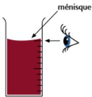
On appelle ménisque la courbure de la surface d'un liquide dans un récipient. Dans une éprouvette, un liquide tel que l'eau colle à la paroi et le ménisque prend une forme concave. La lecture du volume de liquide doit se faire au point le plus bas du ménisque. De plus, la lecture doit s'effectuer à la hauteur des yeux (voir Erreur de parallaxe, p. 96).
