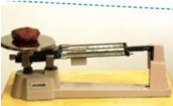
Pour utiliser correctement la balance à triple fléau, il faut :
