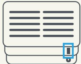
1. Verbinden Sie das mitgelieferte Netzwerkkabel sowohl mit dem Glasfaser-Modem (NT) als auch mit Ihrem WLAN Plus Router (**blauer Pfeil**). Achten Sie bitte darauf, dass das Netzwerkkabel immer mit dem obersten LAN-1-Anschluss (Beschriftung: WAN NT) verbunden werden muss.
