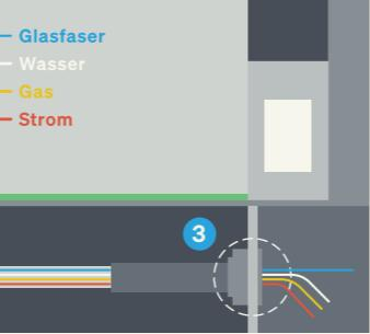
Unsere Empfehlung ist der Einbau eines Mehrpartenanschlusses. Über die Mehrparteneinführung wird das Hausanschlussröhren ohne bohren in den Hausanschlussraum geführt. Bei einem bereits vorhandenen und frei zugänglichen Mehrpartenanschluss kann dieser für die Einführung des Glasfaser-Kabels ins Haus genutzt werden. Alternativ wird ein kleines Loch von 16 mm in die Hauswand gebohrt und die Glasfaser durchgeführt. Anschließend wird das Loch luft- und wasserdicht verschlossen.
