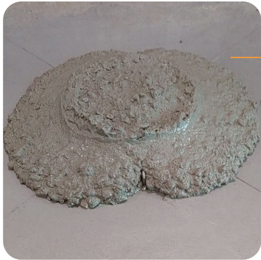
Referenzbeton (Herkömmliches Fließmittel):
