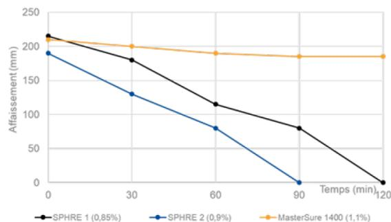
Exemple d'amélioration du maintien de maniabilité sur un béton de Génie Civil en CEM-III/A.
