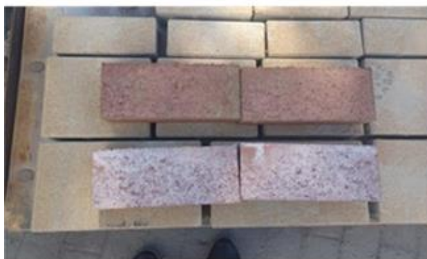
Na obrázku nahoře – vzorky s použitím přísady MasterCast 756 Na obrázku dole – referenční vzorky
