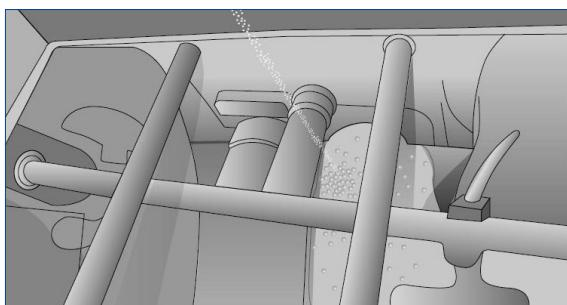
Mittels Pumpenhüben die Mischung solange bewegen, bis das Pulver vollständig aufgelöst ist. Die optimale Wirkung wird erzielt, wenn nach der Beigabe von MasterRoc<sup>®</sup> LUB I, 2- bis 3-mal rückwärts gepumpt wird. Dies sorgt für die optimale Durchmischung des Produktes.
