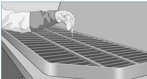
1 Beutel (200 g) in den mit 25 Liter Wasser gefüllten Trichter der Betonpumpe geben. Für längere Pumpleitungen oder grösere Betonpumpen die Menge entsprechend erhöhen.
