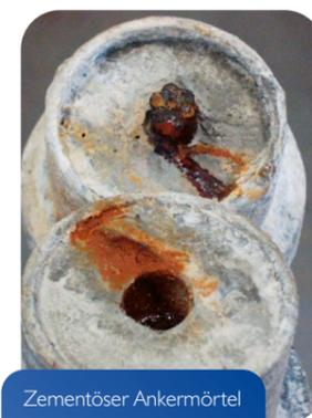
Zementöser Ankermortel ohne Korrosionsschutz
