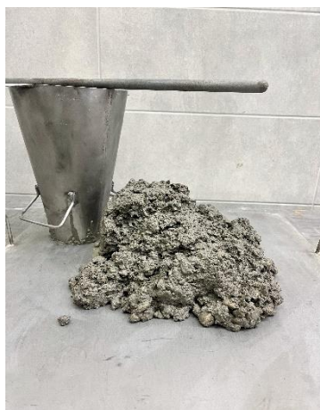
Fot.3 .Beton referencyjny [REC1]
