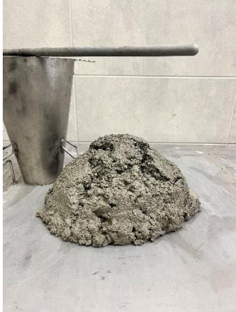
Fot.4 Beton z dodatkową ilością cementu [REC2]
