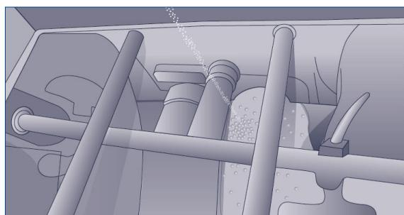
Agiter le mélange en actionnant la pompe jusqu'à dissolution complète de la poudre. Afin d'obtenir un mélange et une efficacité optimales, il est recommandé après adjonction du MasterRoc<sup>®</sup> LUB I, d'actionner la pompe 2-3 fois en arrière.
