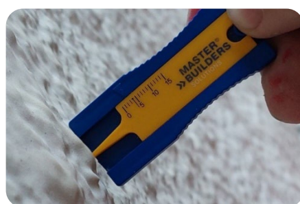
Photo 20 : Le contrôle de l'épaisseur peut se faire au moyen d'une simple jauge de profondeur, illustrée ci-dessus
