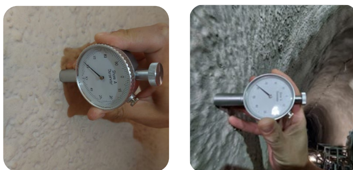
Photo 21 : Mesure de la dureté Shore A
