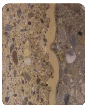
Photo 1 : MasterRoc MSL 345 adhérent au béton sur ses deux faces
