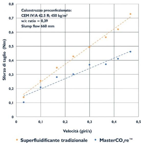
Fig. 1: Prestazioni reologiche del calcestruzzo con MasterCO<sub>2</sub>re 3400 (Bingham ottenuto con reometro Reiner – Rivlin)
