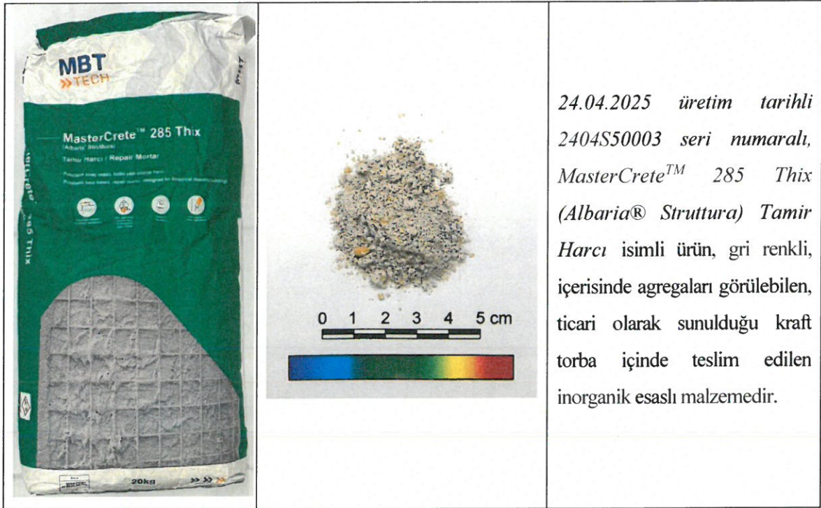
Şekil 1. İnceleme Konusu MasterCrete™ 285 Thix (Albaria® Struttura) Tamir Harcının Görüntüsü ve Tanımı
