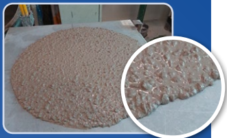
Beton mit 61 \text{ kg/m}^3 geringerem Feinanteil MIT MasterMatrix® LF
