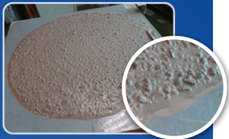
Beton mit 61 \text{ kg/m}^3 geringerem Feinanteil OHNE MasterMatrix® LF
