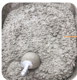
Aspect béton MasterPolyheed 787 à T60
