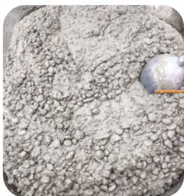
Aspect béton témoin à T60
