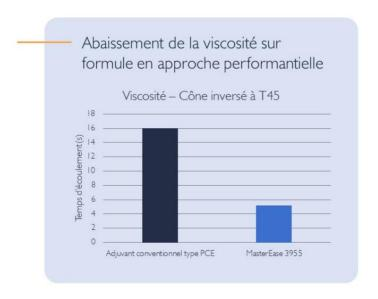
MasterEase 3955 est spécifiquement conçu pour les chantiers nécessitant un béton à très faible rapport E/C, un long maintien d'ouvrabilité et des hautes performances de pompage longue distance. En outre, il convient particulièrement aux bétons bas carbone formulés par les approches performantielles, une démarche innovante et prédictive visant à améliorer la durabilité, la résistance et à réduire l'impact environnemental.
