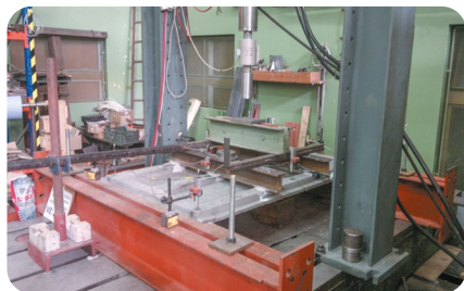
Badania wytrzymałości na rozciąganie przy zginaniu płyt z UHPC z mikrodrucikami MasterFiber 482.
