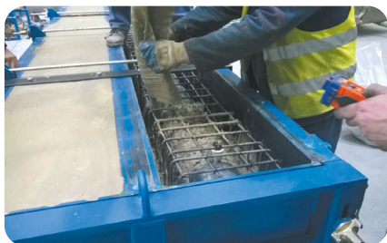
Elementy odwadniające z makrowłóknami MasterFiber 230.
