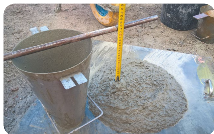
Badanie opadu stożka mieszanki z makrowłóknami MasterFiber I5I SPA.
