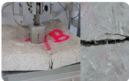
Badania betonu z makrowłóknami MasterFiber I5I SPA na rozciąganie przy zginaniu.
