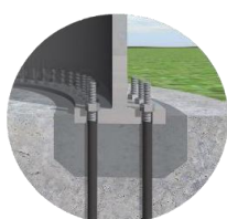
Diseño de zanja profunda
