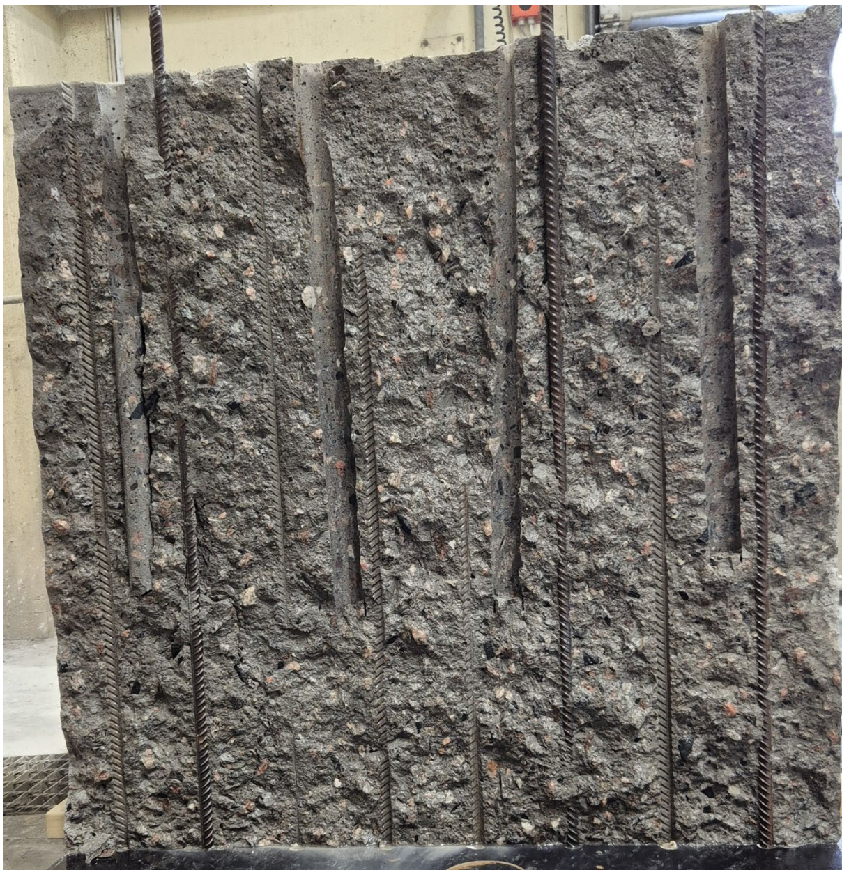
Bild 1: Snitt vid första armeringsraden med hänseende till gjutrörets placering
