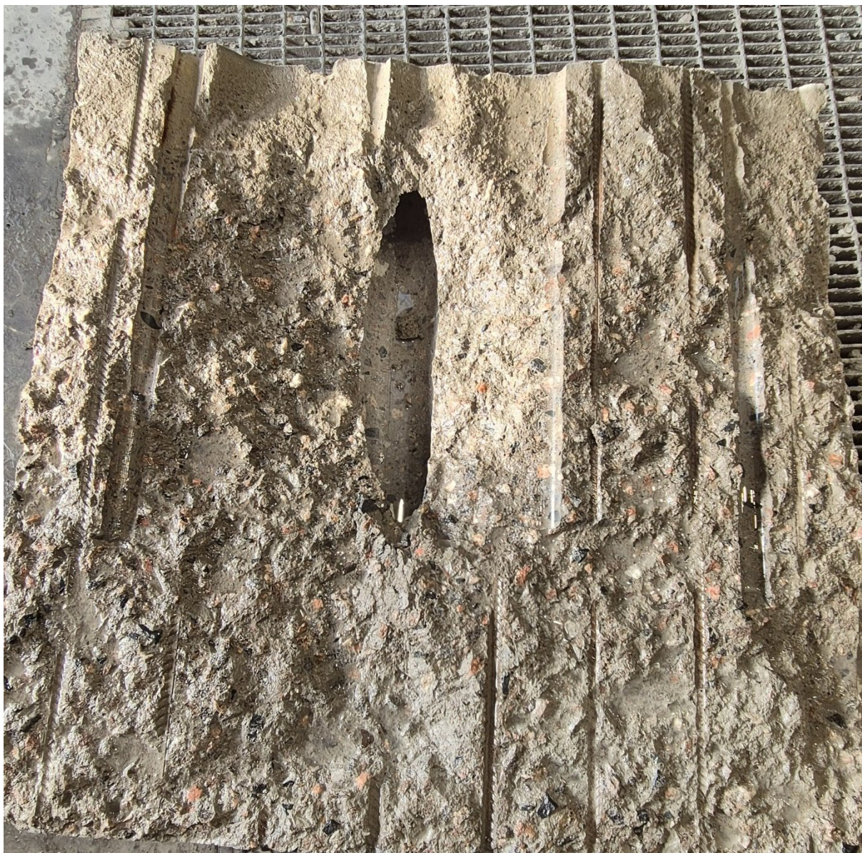
Bild 3: Snitt vid andra armeringsraden med hänseende till gjutrörets placering. Man ser en viss sten separation men inget som påverkade så pass att hållfastheten inte blev godkänd.
