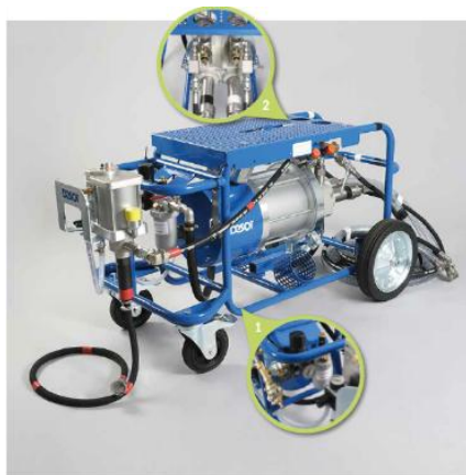
Beispiel einer Dreikomponenten-Pumpe
