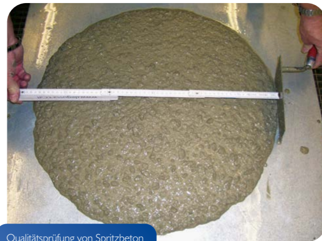
Qualitätsprüfung von Spritzbeton
