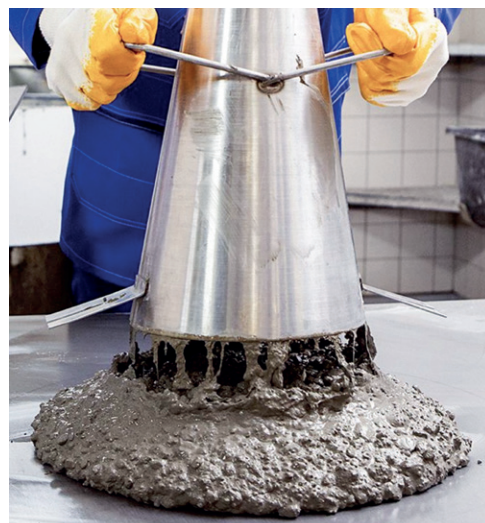
Mieszanka betonowa oparta na superplastyfikatorze MasterCO 2 re
