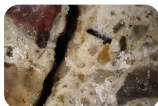
Agrandissement d'une fissure capillaire dans le béton
